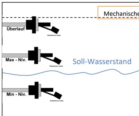
Mechanischer Überlauf ist über dem Überlauf-Schwimmerschalter zu installieren
